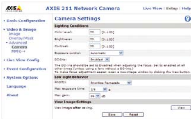
Рис. 3.2d Интерфейс пользователя камеры с возможностью установки, кроме прочего, выдержки при плохом освещении.
