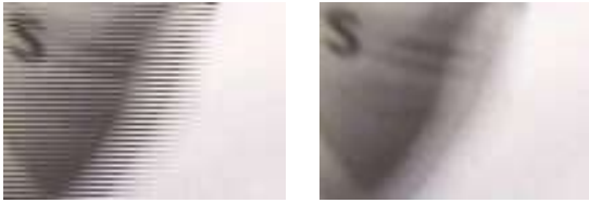
Рис. 5.5а Слева: увеличенное чересстрочное изображение, показанное на мониторе компьютера. Справа: то же самое чересстрочное изображение с примененной к нему технологией деинтерлейсинга.
