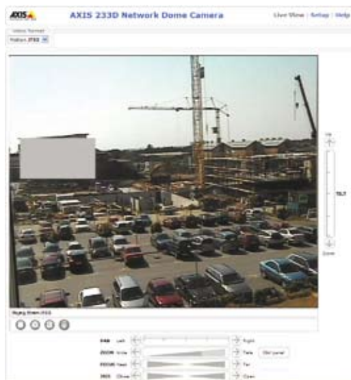
Рис. 2.2с Благодаря встроенной защитной маске (серый прямоугольник на изображении) камера не нарушит неприкосновенность частной жизни в зонах, которые не должны быть охвачены видеонаблюдением.
