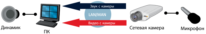
Рис. 8.3а В режиме симплекс звук передается только в одном направлении. В таком случае звук отправляется с камеры оператору. Такой режим используется при удаленном и охранном наблюдении.
