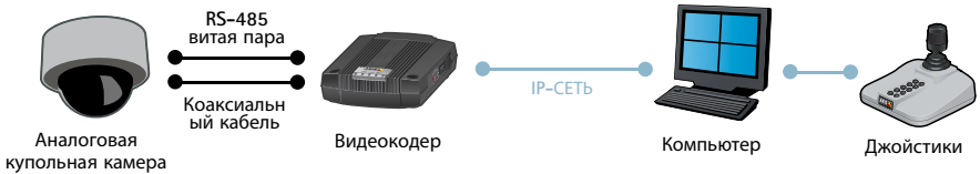
Рис. 5.4а Аналоговая купольная PTZ-камера может контролироваться через последовательный порт видеокодера (например, RS-485), что позволяет дистанционно управлять ей через IP-сеть.
