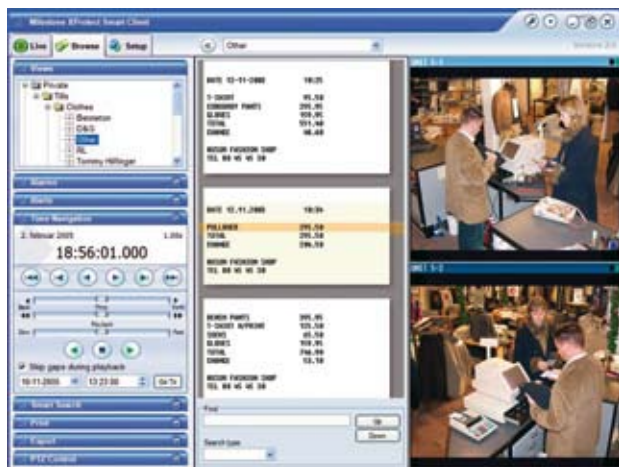
Рис. 11.4а Пример системы кассового терминала, интегрированного с охранным наблюдением. На моментальном снимке с экрана отображаются денежные поступления наряду с видеоклипами события. Изображение является собственностью компании Milestone Systems.
