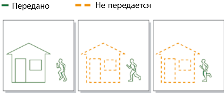
Рис. 7.1б При кодировании по отличиям полностью кодируется только первое изображение (I-кадр). В двух последующих изображениях (P-кадрах) содержатся ссылки на статичные элементы первого изображения (например, дом). Тогда как движущиеся объекты (в данном случае бегущий человек) кодируются с помощью векторов движения. Таким образом, уменьшается объем данных, подлежащих дальнейшей пересылке и хранению.
