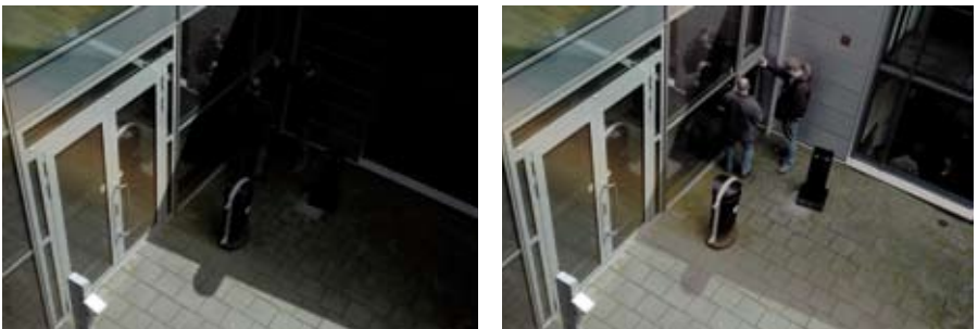
Рис. 3.5а Слева изображение без широкого динамического диапазона. Справа изображение с применением широкого динамического диапазона.
