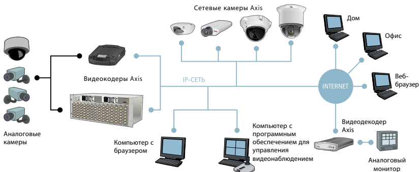
Рис. 5.1а Пример интеграции аналоговых видеокамер и мониторов с сетевыми видеосистемами с помощью видеокодеров и декодеров.
