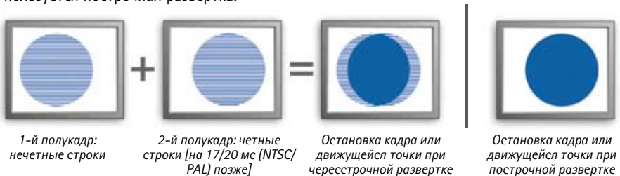
Рис. 3.4а Слева изображение с чересстрочной разверткой на экране (компьютера) с построчной разверткой. Справа изображение с построчной разверткой на экране компьютера.
