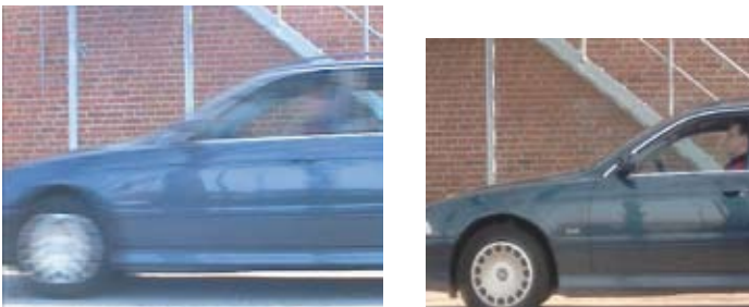
Рис. 3.4б Слева полноразмерное JPEG-изображение (704x576 пикселей) с аналоговой камеры, использующей чересстрочную развертку. Справа полноразмерное JPEG-изображение (640x480 пикселей) с камеры производства Axis, которая использует технологию построчной развертки. Обе камеры использовали один и тот же тип объектива, и скорость автомобиля была одинаковой — 20 км/ч. Задний план четкий на обоих изображениях. Однако водитель отчетливо виден только на изображении, которое использует технологию построчной развертки.
