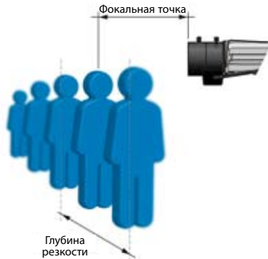
Рис. 3.2e Глубина резкости. Представьте строй людей, стоящих друг за другом. Если фокус находится в середине строя и возможно определить лица всех, кто стоит перед фокусом и за ним на расстоянии больше 15 метров, то глубина резкости хорошая.
