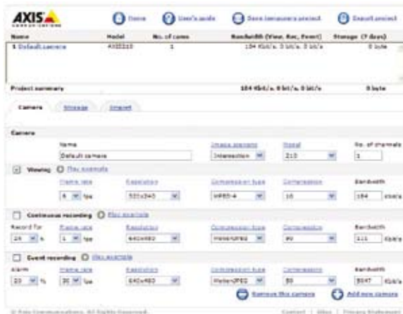
Рис. 12.1а Программа AXIS Design Tool обладает усовершенствованной функцией управления проектами, которая позволяет рассчитывать требования к полосе пропускания и памяти для больших сложных систем.
