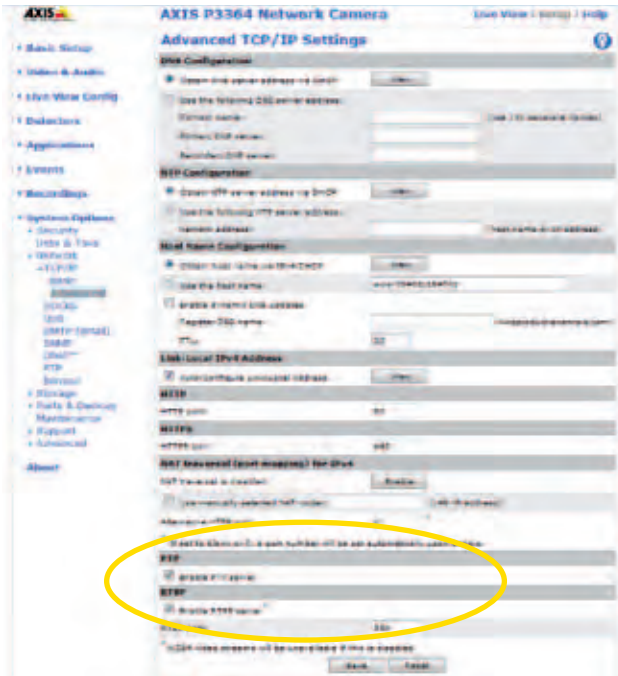
РИС 9.2b Сетевая видеоаппаратура Axis поддерживает функцию NAT traversal для настройки переадресации портов.
