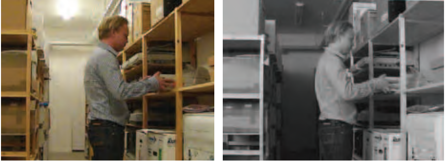
РИС 2.2а Слева показано изображение, сделанное с ИК-фильтром (день). А справа без ИК-фильтра (ночь)..
