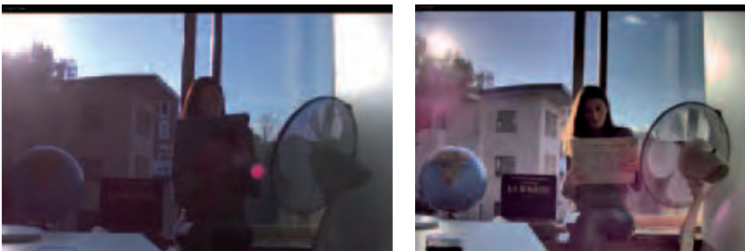
РИС 2.2d Слева показан кадр, полученный с обычной видекамеры. А справа кадр с видекамеры, имеющей широкий динамический диапазон.
