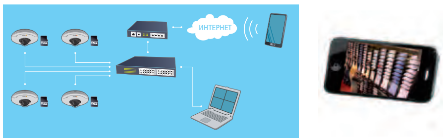
РИС 11.1б Слева показан пример настройки видеокамер с картами памяти, коммутатора с поддержкой PoE, маршрутизатора (беспроводной доступ и через Интернет), ноутбука и смартфона в программе AXIS Camera Companion. Справа показано как выглядит версия программы для смартфона.
