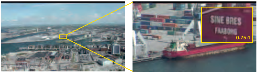
РИС 2.4i Слева показано изображение общего плана, а справа увеличенный в 20 раз фрагмент изображения. Оба кадра сделаны купольной PTZ-видеокамерой стандарта HDTV 1080p. Как видно, можно прочитать надпись на борту судна, находящегося на расстоянии 1,6 км (1 миля) от видеокамеры.
