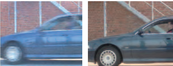
РИС 3.5б Слева показано полноразмерное изображение в формате JPEG (704x576 пикселей), полученное с аналоговой видеокамеры с чересстрочной разверткой. Справа показано полноразмерное изображение в формате JPEG (640x480 пикселей), полученное с сетевой видеокамеры Axis с прогрессивной разверткой. На обеих видеокамерах стоят объективы одного типа и скорость машины везде 20 км/ч (15 миль/ч). Задний план получился четким на обоих изображениях, но водителя можно хорошо рассмотреть только на изображении с видеокамеры с прогрессивной разверткой.
