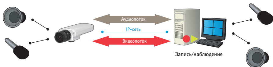
РИС 8.2а Система сетевого видеонаблюдения со встроенной поддержкой звука. Видео и аудио потоки передаются по одному сетевому кабелю.
