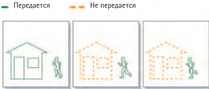
РИС 7.1б При кодировании отличающихся данных, только первый кадр (I-кадр) кодируется полностью. Статические элементы изображения двух последующих кадров (P-кадры) сравниваются с первым кадром, в нашем примере это дом. И кодируются только движущиеся объекты, в нашем случае это бегущий человек. При кодировании используются векторы движения. Таким образом, уменьшается количество передаваемых и хранимых данных.
