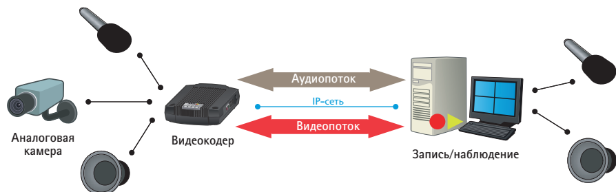
РИС 8.2б Некоторые видеокодеры имеют встроенную поддержку звука, поэтому могут передавать звук, даже если система видеонаблюдения оснащена аналоговыми видеокамерами.
