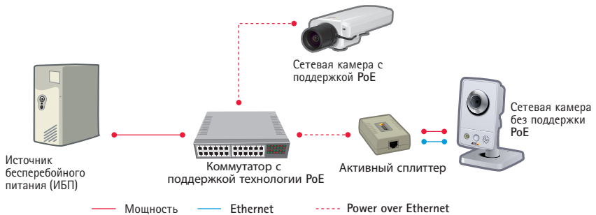
РИС 1.2b Система, где реализована технология питания по сети (PoE).
