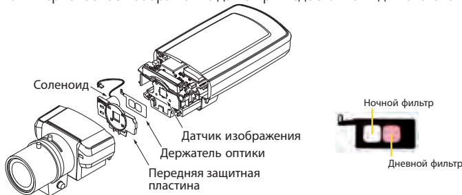
РИС 3.3a Иллюстрация и фотоснимок, где показан инфракрасный фильтр (день/ночь) на держателе, который в этой видеокамере сдвигается в сторону. Днем перед матрицей находится красная часть фильтра, а ночью прозрачная.
