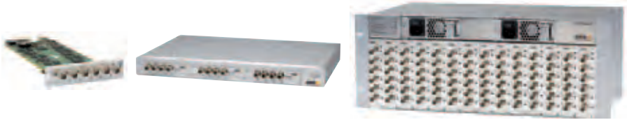
РИС 4.3а Бескорпусные видеокодеры и стойки, поддерживающие разное количество аналоговых видеокамер и имеющие разные возможности. К стойке AXIS Q7900 Rack (крайняя справа), полностью укомплектованной 6-канальными бескорпусными видеокодерами, можно подсоединить до 84 аналоговых видеокамер.
