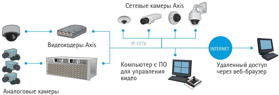
РИС 1.1а В состав системы сетевого видеонаблюдения входят разные компоненты, например, сетевые видеокамеры, видеокодеры и программное обеспечение видеонаблюдения. Все другие компоненты являются стандартным ИТ оборудованием, включая хранилища данных, серверы и сетевую аппаратуру.
