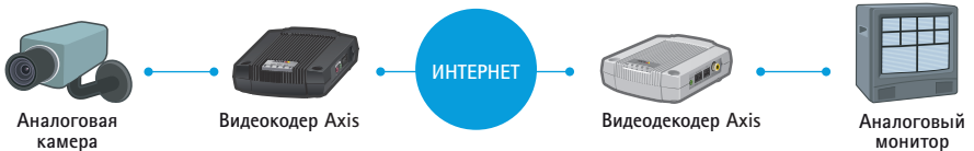
РИС 4.6а Видеокодер и видеокодер можно использовать для передачи видеосигнала с аналоговой видеокамеры на аналоговый монитор, установленный далеко от нее.
