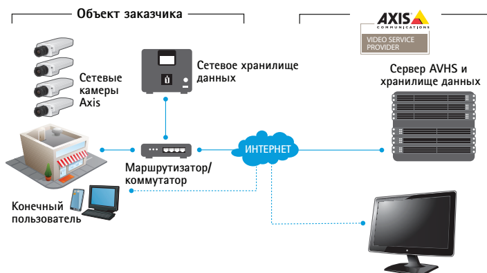
РИС 11.1с Сервис видеохостинга AXIS Video Hosting System и хранение видеозаписей вне объекта. Пользователь может просматривать изображение с камер наблюдения и воспроизводить видеозаписи, подключившись к порталу провайдера видеохостинга.
