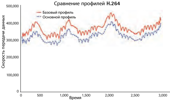
РИС 7.2а При сопоставимом качестве изображения, видеокодек Main Profile H.264, используемый компанией Axis, даёт меньший битрейт, чем видеокодек Baseline Profile H.264.
