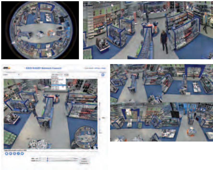
РИС 2.4с Фиксированная купольная панорамная видеокамера Axis с матрицей 5Мп поддерживает разные режимы просмотра: 360-градусная панорама, развернутая панорама, квадрантный режим и окно просмотра с цифровым PTZ-управлением.
