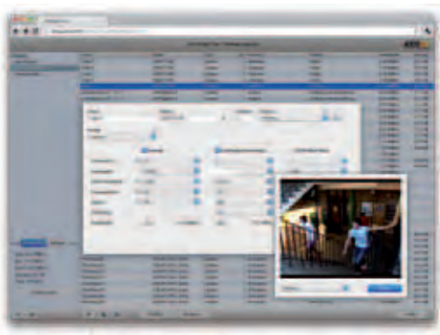
РИС 12.1а Утилита AXIS Design Tool позволяет быстро и легко рассчитать требуемую полосу пропускания и объем памяти для хранения видеозаписей для большой и сложной системы видеонаблюдения.
